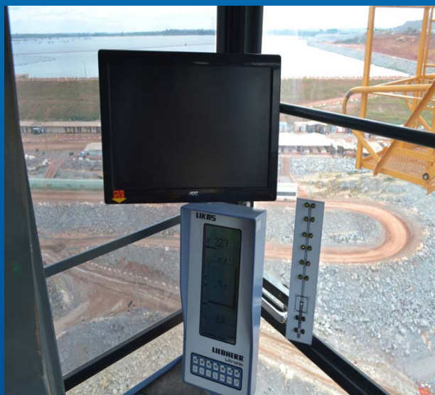
Monitor para Visualização das Imagens das Câmeras e Diagrama que indica qual Sensor foi Acionado
